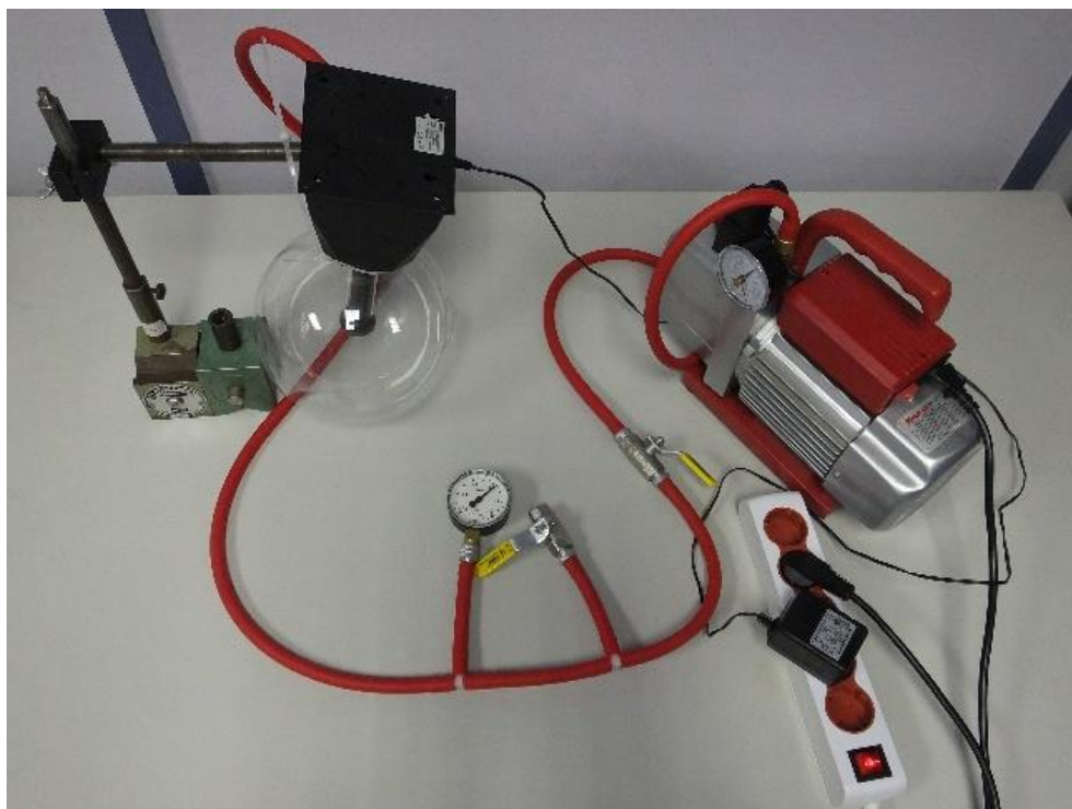
Slika 4.9.1. Eksperimentalni postav za vježbu plazmena kugla
