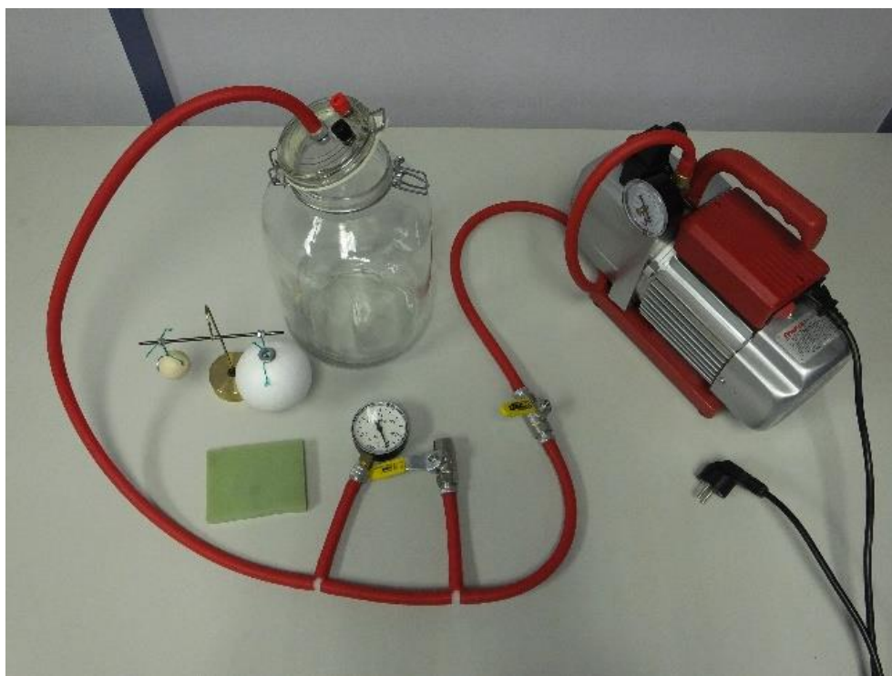
Slika 4.5.1. Eksperimentalni postav za vježbu uzgon u zraku
